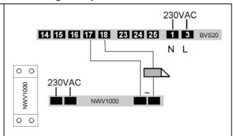
Optional kann der Türöffner mit einem zusätzlichen Schlüsselschalter (Postschloss) aktiviert werden. Schließen Sie das Postschloss nur so wie im Schaltungsbeipiel an!
